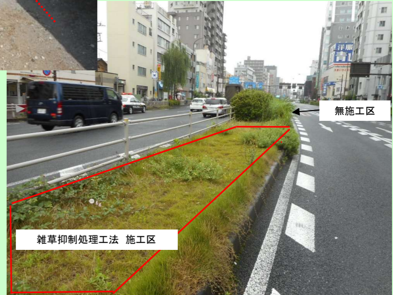
東京都文京区千石(国道17号) 施工日:2012年2月 撮影:施工後 約53ヶ月
